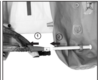
5. Schieben Sie das kurze „2-teilige Montagerohr“ durch die andere Seite des Rumpfbefestigungslochs in das lange Montagerohr. Vergewissern Sie sich, dass der Federknopf eingerastet ist.
