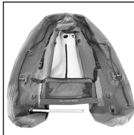
3. Falten Sie das „Netzlineal“, sodass der Rand des Saums auf das lange „2-teilige Montagerohr“ zeigt auf.
